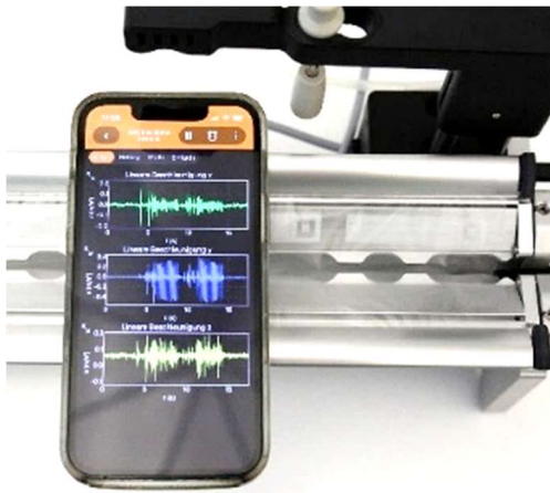
Abb. 2: Smartphone auf dem Beutelhalter mit laufender phyphox-App während der Datenaufzeichnung.
